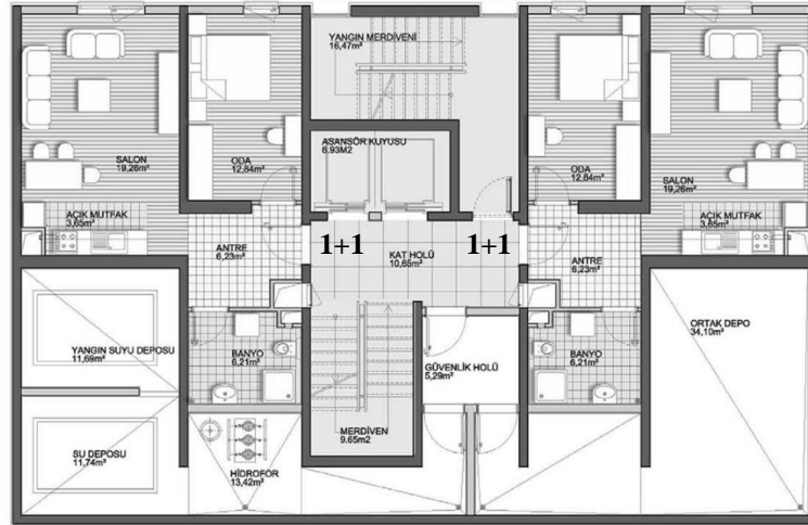
Figure 2.12. B1 Block Floor Plan 1+1 Apartments (TOKİ Kayabaşı Yerleşimi 879-1 ve 876-3 Ada Toplu Konut Projesi, n.d.)
