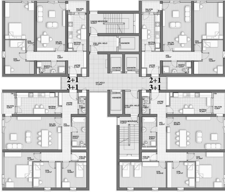
Figure 2.11. A Block Floor Plan 2+1 (2 Units) and 3+1 (2 Units) Apartments (TOKİ Kayabaşı Yerleşimi 879-1 ve 876-3 Ada Toplu Konut Projesi, n.d.)
